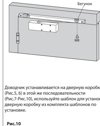
Доводчик устанавливается на дверную коробку (Рис.5, 6) в этой же последовательности (Рис.7-Рис.10), используйте шаблон для установки на дверную коробку из комплекта шаблонов по установке.
